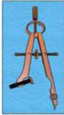
شكل رقم (٥) فرجار بعجلة ضبط وحامل لقلم رصاص لرسم الدوائر والأقواس
